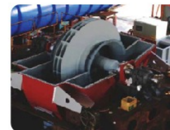
Quạt tuần hoàn CDQ (CDQ circulation fan)
