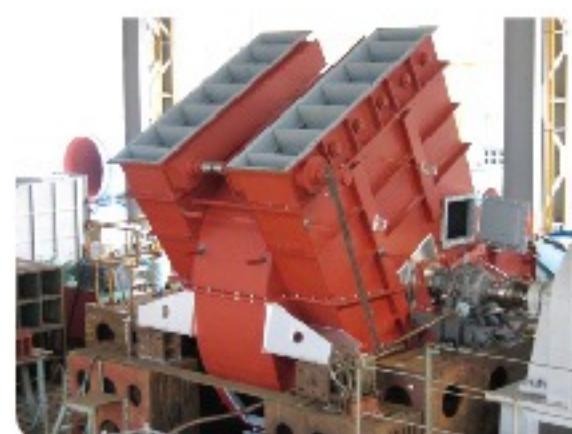
Quạt hút gió lò hơi nhiệt điện (Induced draft fans)
