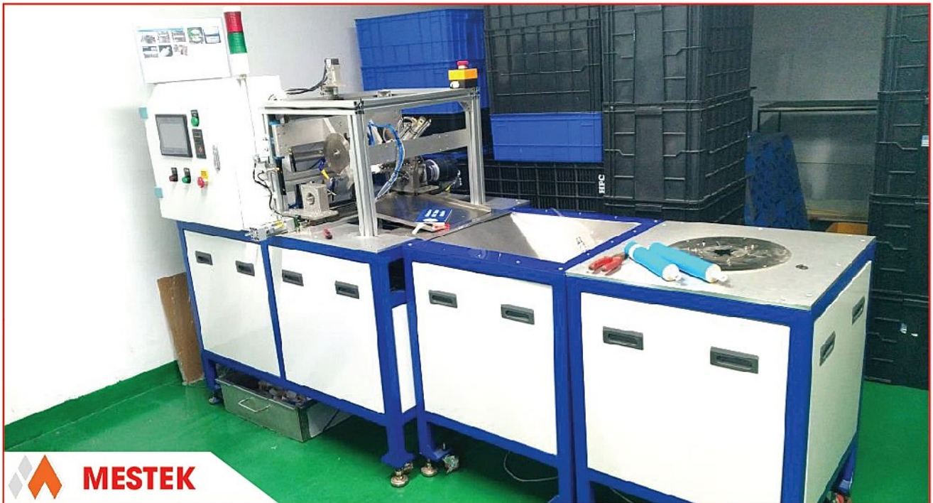
Máy cắt, test lõi lọc RO Công ty CP sản xuất và công nghệ môi trường Nam Sơn – Hoàng Mai – Hà Nội
